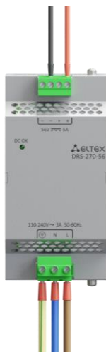
Рисунок 63 — Подключение питания к DRS-270-56
