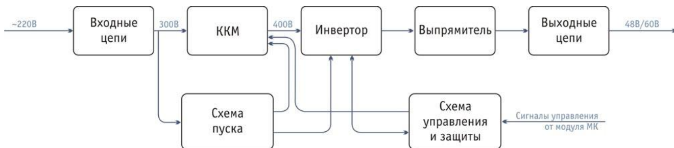
Рисунок 2 – Структурная схема модуля МП800
