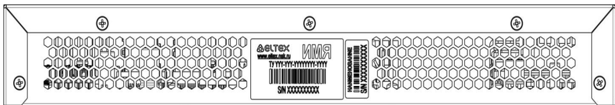
Рисунок 30 – Задняя панель MES2308, MES2308P, MES2308P DC, MES2308R
