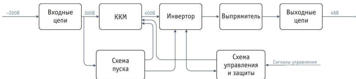
Рисунок 8 – Структурная схема модуля МП260
