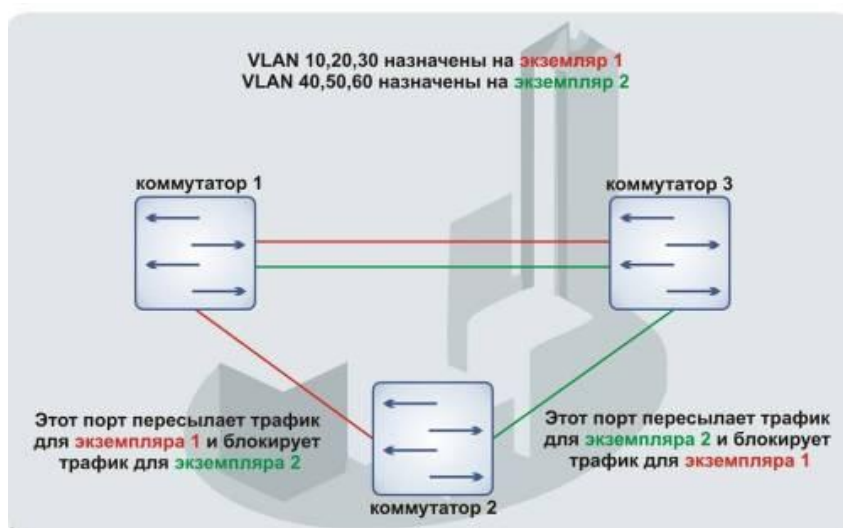
Рисунок 15 - Настройка протокола множества связующих деревьев
