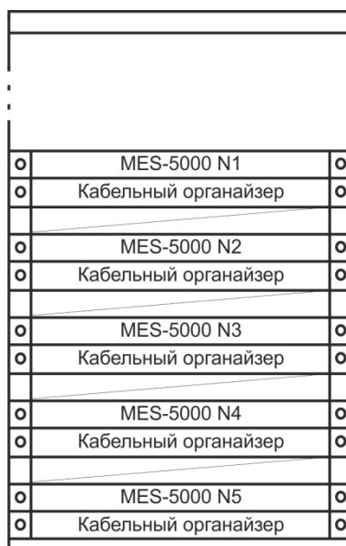
Рисунок 9 – Размещение коммутаторов в стойке
