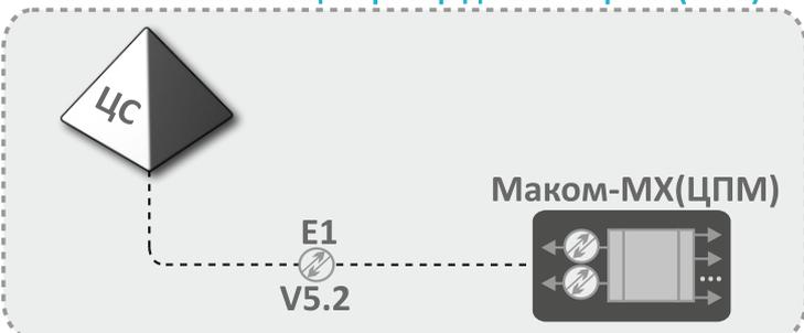
При использовании процессора ЦПМ, оборудование Маком-МХ позволяет создавать абонентские концентраторы от АТС (БКП-М) или другой АТС по протоколу V5.2.
