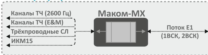
Аппаратура позволяет производить конвертирование протоколов тональной сигнализации каналов ТЧ (2600Гц) в протоколы сигнализации 2ВСК потоков Е1 и обратно (не более 60 каналов ТЧ).
