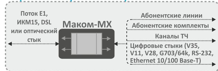
В режиме оконечного мультиплексора аппаратура позволяет подключать устройства через аналоговые и цифровые стыки и осуществлять соединение с удалёнными устройствами по потокам Е1, ИКМ15 или по оптическому кабелю по технологии TDMoP.
