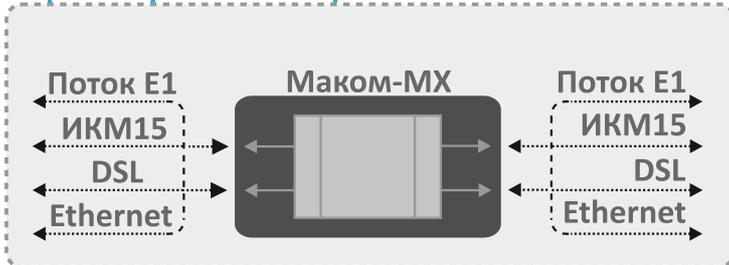
Аппаратура выполняет функции кроссовой коммутации – электронного кроссирования информации 64 кбит/с и  $n \times 64$  кбит/с, которая содержится в канальных интервалах входящих сигналов 2048 кбит/с и 1024кбит/с, на позиции любых исходящих канальных интервалов исходящих сигналов 2048 кбит/с и 1024 кбит/с. Максимальное число формируемых аппаратурой цифровых потоков Е1 – 32.
