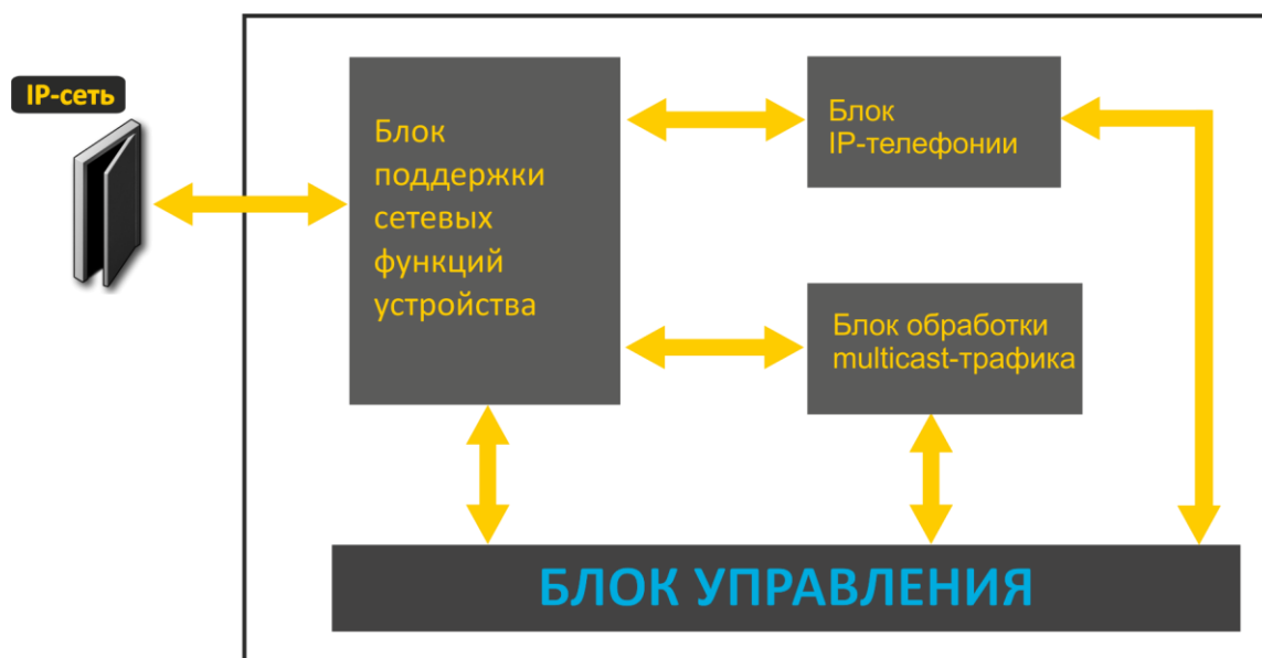
Рисунок 3 – Функциональная схема устройства серии RG-5421G-Wac
