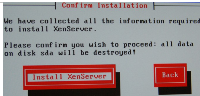
Рисунок 24 – Мастер установки XenServer. Подтверждение инсталляции
